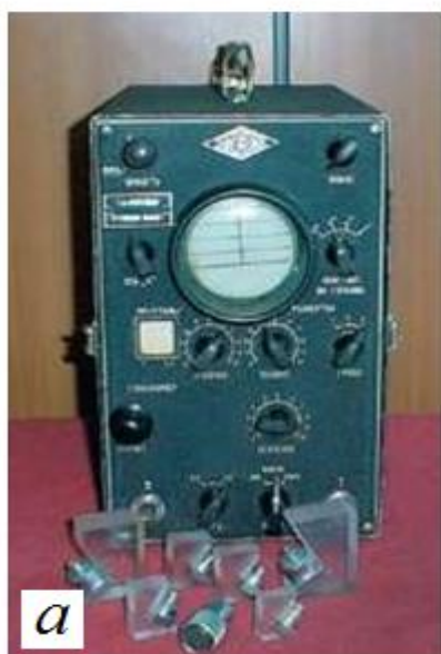
Рис. 2. Зовнішній вигляд електромагнітних дефектоскопів: а – мод. ВД1; б – мод. ВД-10А; в – мод. ВДЗ-81 Eddyson; г – мод. ВІТ-4
