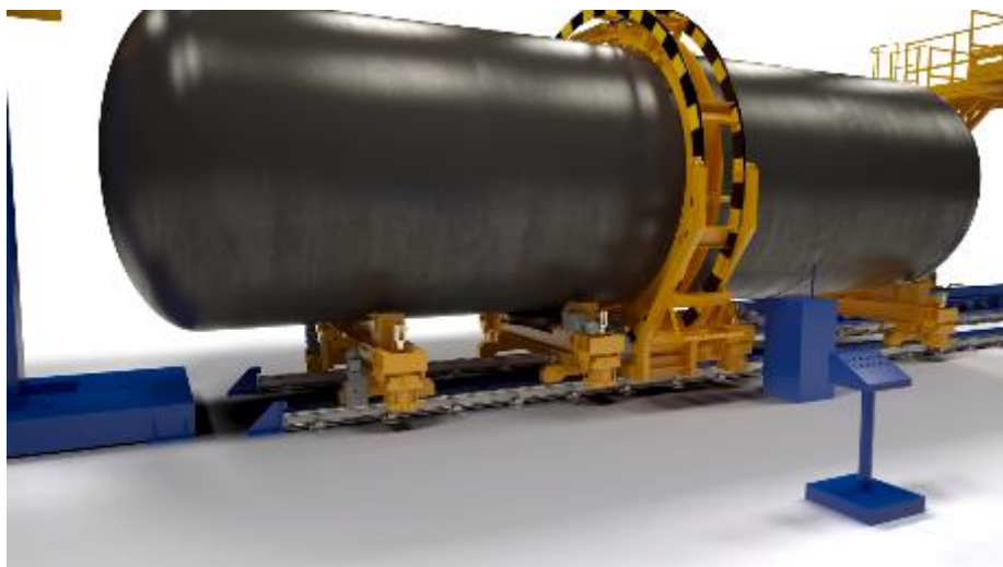
Рис. 24. Встановлення двох других котлів та їх центрування в центраторі
