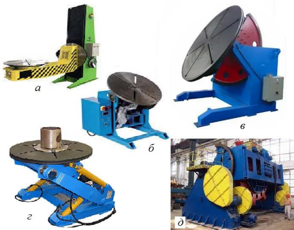
Рис. 6. Маніпулятори та позиціонери: а – консольний маніпулятор; б і в – карусельні маніпулятори; з – маніпулятор з гідравлічними домкратами кута нахилу шайби, що обертається у межах 90^\circ ; д – позиціонер вантажно-підйомністю до 10 тон
