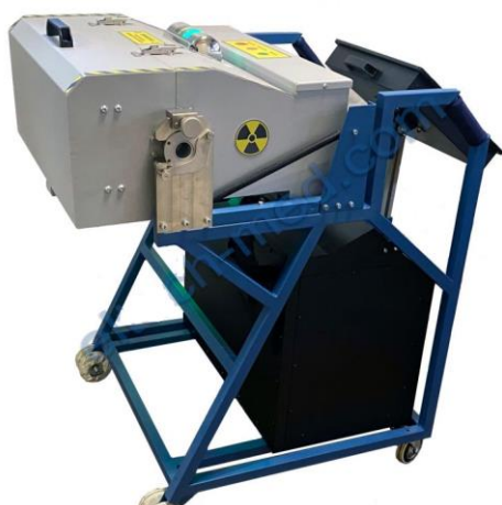
Рис. 1. Установки рентгеновського контролю РУП-120
