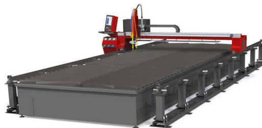
Рис. 18. Верстат плазмового різання мод. Basic Cut
