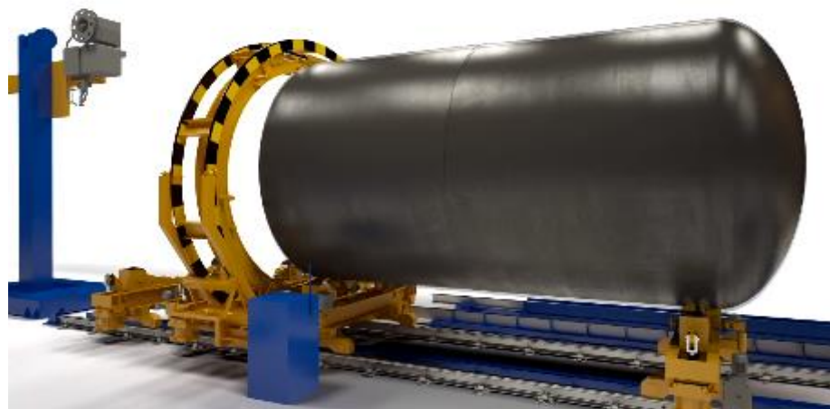
Рис. 23. Зняття другого котла з універсального стенду на проміжне зберігання та повторення технологічного процесу виготовлення першого та другого котла
