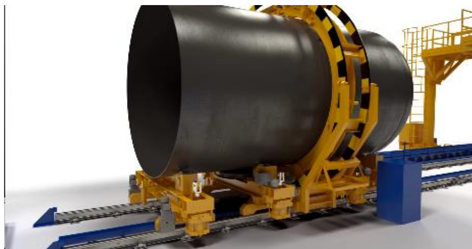
Рис. 21. Пересування другого котла в крайнє ліве положення з підтисканням зварного шва флюсовою подушкою
