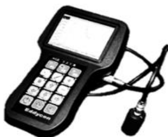
Рис. 2. Зовнішній вигляд електромагнітних дефектоскопів: а – мод. ВД1; б – мод. ВД-10А; в – мод. ВДЗ-81 Eddyson; г – мод. ВІТ-4
