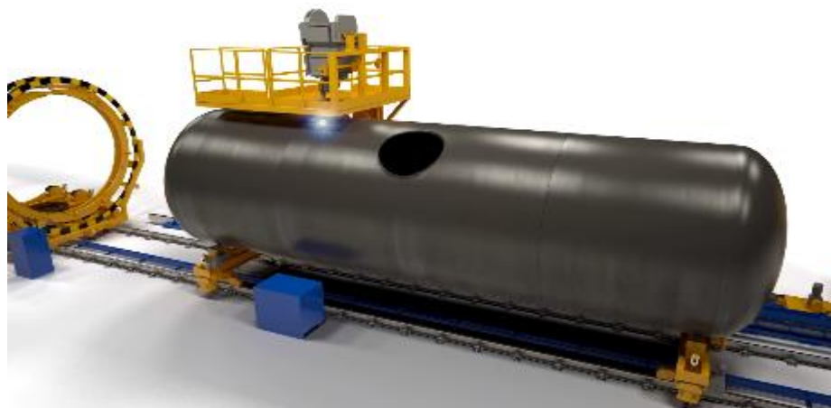
Рис. 28. Переустановка велосипедного візка та виконання другого зварного шва при постійному обертанні котла цистерни зі зварювальною швидкістю. Виконання інших зварних швів в тій же послідовності та умовах
