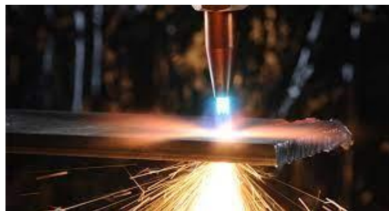
Рис. 18. Газо-полум'яне машинне різання
