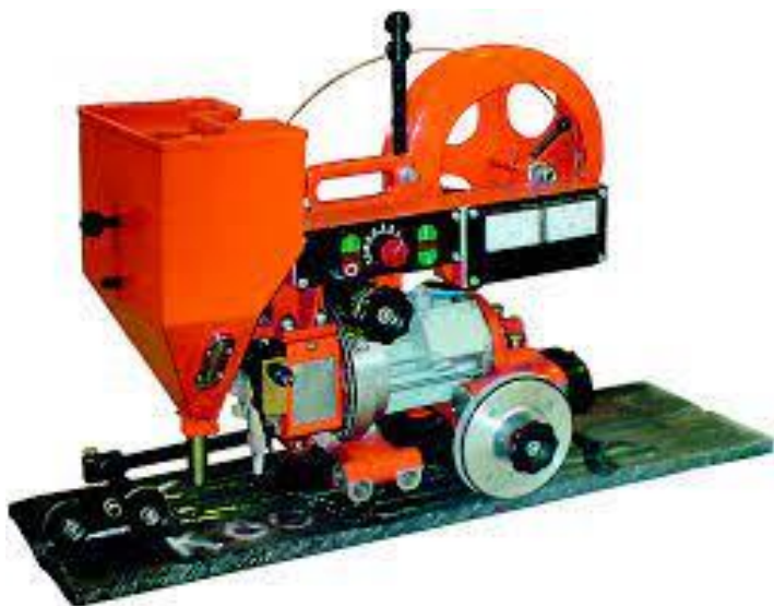
Рис. 4. Зварювальний трактор мод. ТС-16
