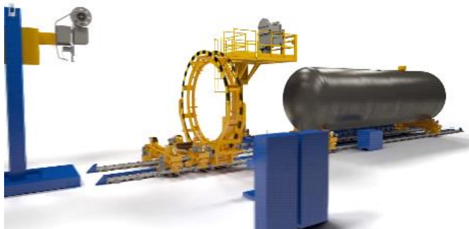
Рис. 30. Зняття котла цистерни зі стану та повторення циклу технологічного процесу по виготовленню наступної цистерни
