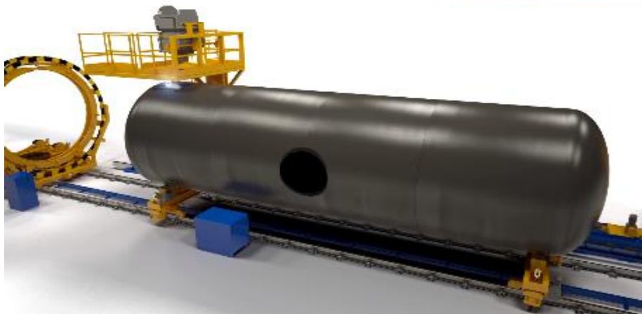
Рис. 28. Переустановка велосипедного візка та виконання другого зварного шва при постійному обертанні котла цистерни зі зварювальною швидкістю. Виконання інших зварних швів в тій же послідовності та умовах
