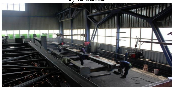
Рис. 3. Складально-зварювальний цех по виготовленню просторових зварних конструкцій типу жорстка рама
