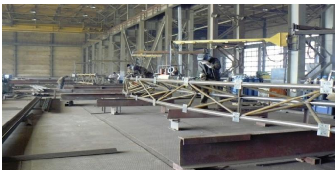
Рис. 1. Складально-зварювальний цех по виготовленню просторових зварних конструкцій типу несуча балка
