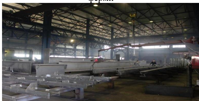
Рис. 4. Складально-зварювальний цех по виготовленню просторових зварних конструкцій типу двотавр
