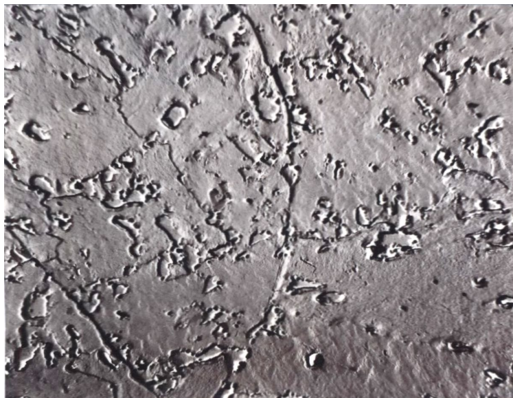
Рисунок 3.4 – Полігональна структура (х 6 000) зерна \alpha -фази ділянки неповної перекристалізації металу ЗТВ зварного з'єднання зі сталі 15Х1М1Ф (ресурс 186 тис. год.)
