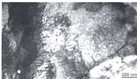
Рисунок 4.6 – Дислокаційні сплетення в зернах \alpha -фази структури ділянки неповної перекристалізації ЗТВ зварних з'єднань зі сталі 12Х1МФ ( \epsilon = 8 \% , початкова стадія розвитку фрагментованої структури)
