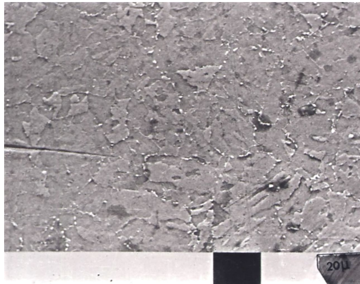
Рисунок 3.3 – Структура металу шва з мікропорами повзучості (сплав 10ХМФ) зварного з'єднання зі сталі 15Х1М1Ф. Ресурс 190 тис. год.
