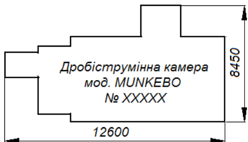
Рис. 22. Темплета дробіструминної камери мод. Munkеbo та номер її на виробництві
