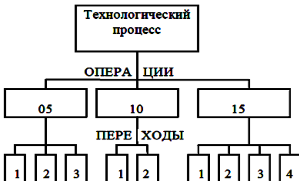
Рис. 1. Структура технологічного процесу: 05, 10, 15 – номери операцій; 1, 2, 3, 4 – номери переходів
