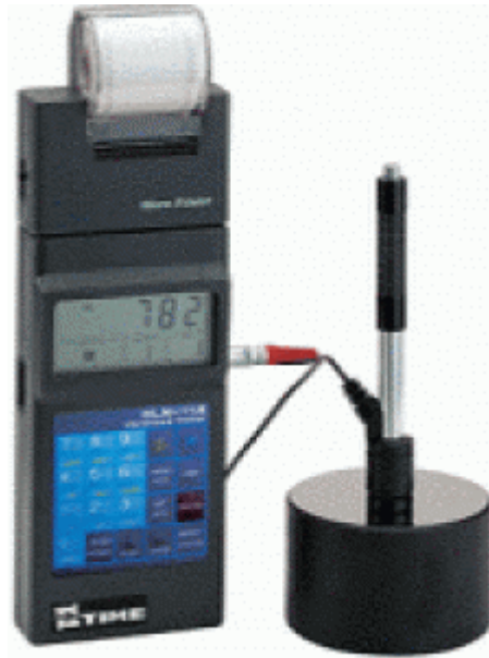
Рисунок 6 – Ультразвуковий портативний твердомер
