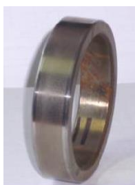
Рис. 3.35. Втулка коробки передач трактора Т-150К
