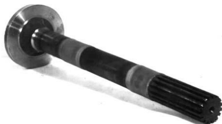
Рис. 3.31. Вал приводу переднього моста трактора Т-155
