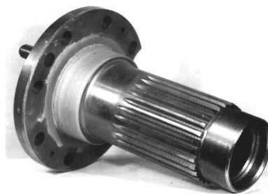
Рис. 3.32. Вал колісного редуктора трактора Т-150К
