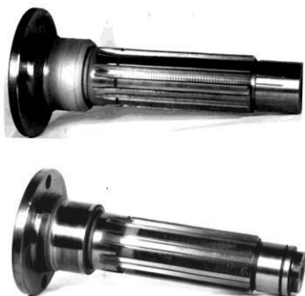
Рис. 3.31. Вал приводу переднього моста трактора Т-155
