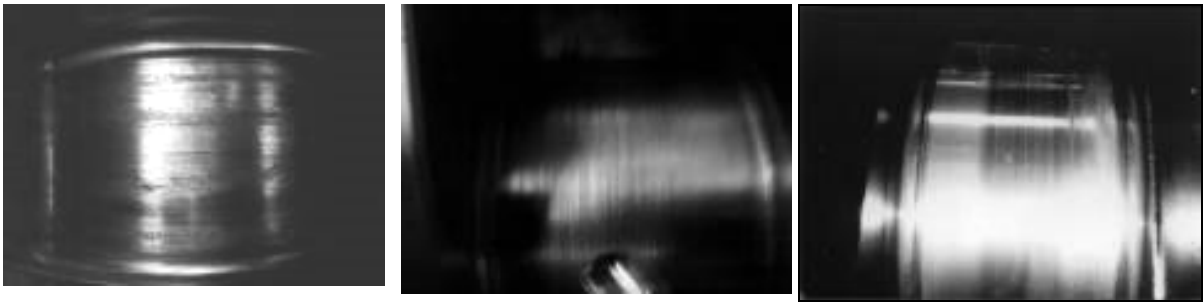
Рисунок 5 – Кільцеве (абразивне) зношування шийки колінчастого вала двигуна типу 5Д49
