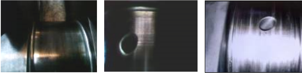
Рисунок 6 – Втомні тріщини на шийці колінчастого вала двигуна типу 5Д49 в умовах обмеженого змащування
