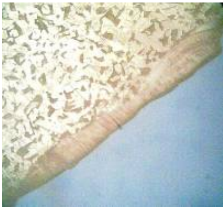
Рисунок 8 – Мікроструктура поперечного шліфа зразка сталі 45 у зоні розряду; \times 100 ; електрод – сталь 08Х18Н10Т
