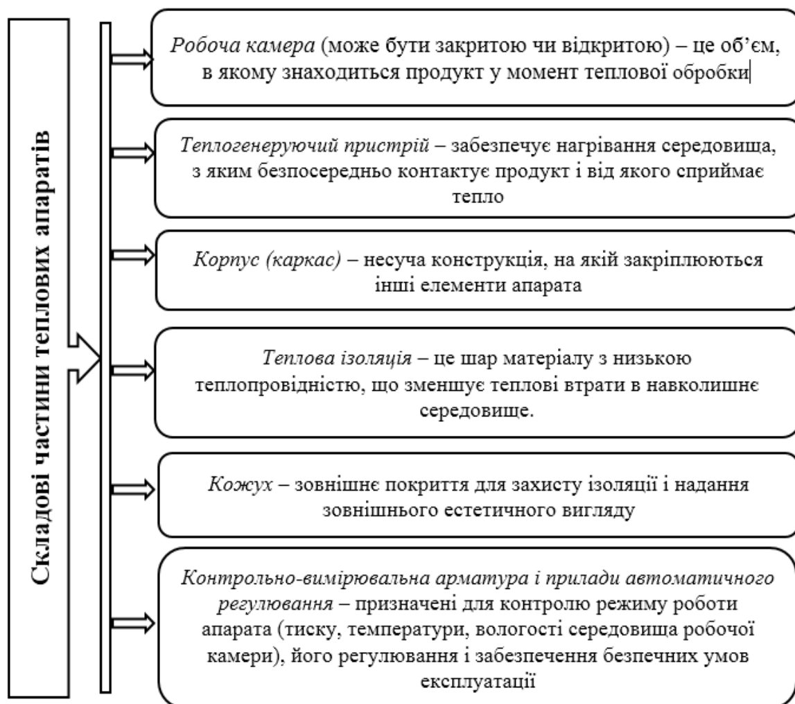
Рисунок 4.14 – Складові частини теплових апаратів
