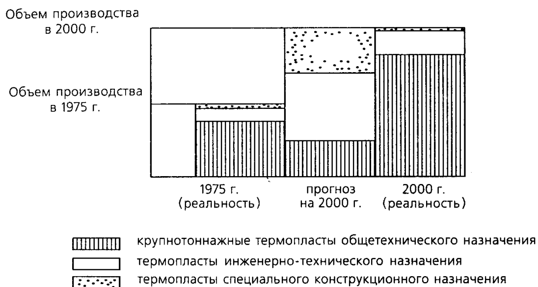
Рис. 1.17 – Соотношение основных видов термопластов (ТП) в общем (100 %) объеме их производства в 1975 г., прогноз 1975 г. на 2000 г. и фактическое соотношение видов ТП в 2000 г.
