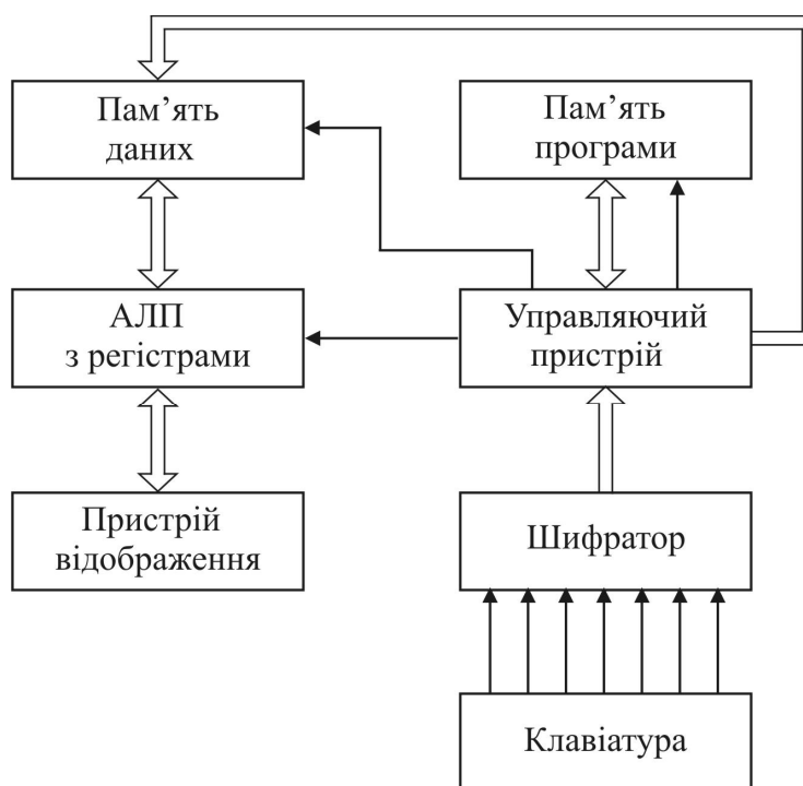
Рисунок 4.5 – Структурна схема програмованого калькулятора
