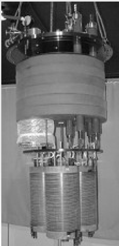
ВТНП котушки струмообмежувача Toshiba-Fujikura
