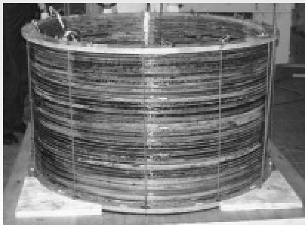
ВТНП котушка обмежувача струму
