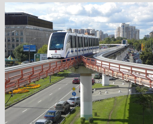
Поїзди на магнітному підвісі використовують для руху асинхронний лінійний двигун. Статор розташований на рухомому складі, а вторинним елементом є монорейка
