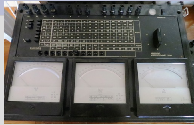
Електровимірювальний комплект К540 (до його складу входить вольтметр, амперметр і ватметр):
