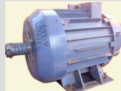
Трифазні загальнопромислові асинхронні двигуни серії А4 призначені для тривалого режиму роботи
