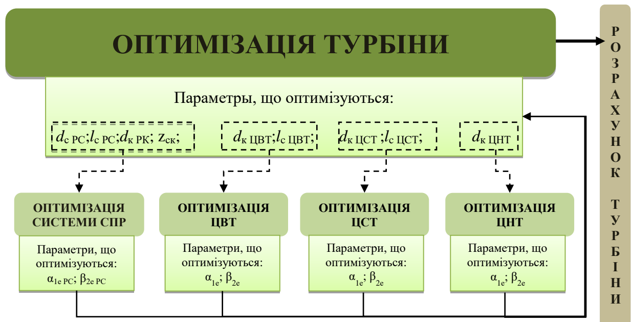
Рисунок 1.3 – Схема другого підходу оптимізації турбіни
