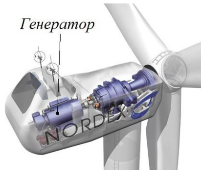
Вітогенератор: перетворення енергії вітру на електрику
