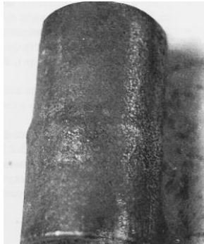
Рисунок 1.5 – Виливок з дефектом «Подутість»
