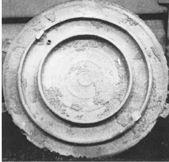
Рисунок 2.2 – Виливок «Кришка люка» з дефектом «Пригар»
