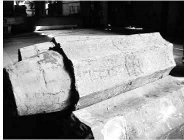
Рисунок 2.1 – Загальний вигляд злитків з поверхневими дефектами
