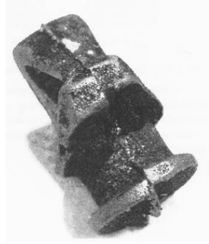
Рисунок 1.4 – Виливок з дефектом «Зміщення»: а – «Кришка»; б – «Наконечник»
