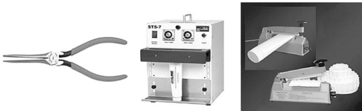
Рис. 19 – Напівавтоматичне та ручне обладнання для запаювання пластикових і закручування алюмінієвих туб
