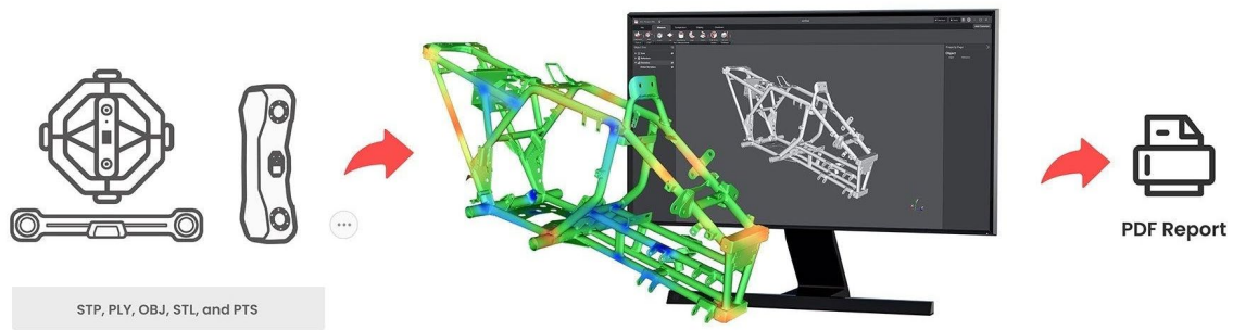
Рисунок 11 – Принцип застосування CAD-інспекції
